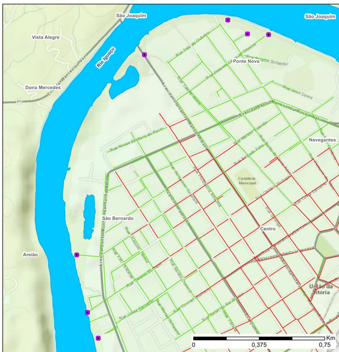
Figura 23: Exutórios da Drenagem urbana de União da Vitória (Médio Iguaçu).
